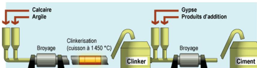
La fabrication du ciment produit beaucoup de CO<sub>2</sub> (gaz à effet de serre) libérées par la combustion de carburant des machines et la calcination des roches.
