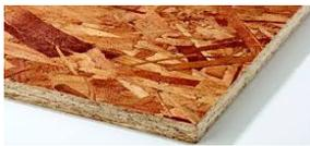
les panneaux structuraux orientés (en anglais, OSB pour Oriented Strand Board) dans une structure bois liés par des vis ou clous.
