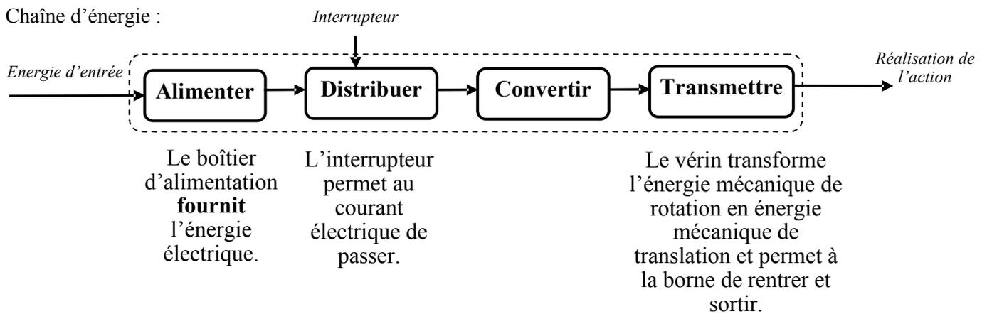
Quelle est la fonction de service principale, les fonctions techniques, les blocs fonctionnels, les solutions techniques et la chaîne d'énergie de cette borne escamotable ?
